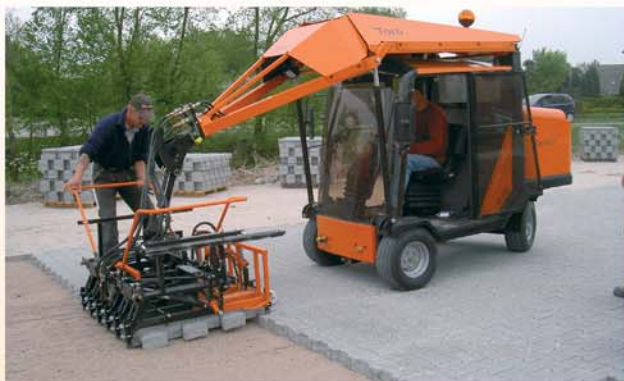
Komfortkabine mit zwei groß dimensionierten Türen und uneingeschränkter Sicht zur Anlegekante
