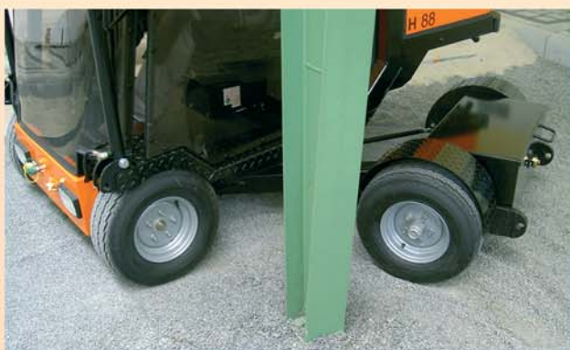
Extreme Wendigkeit bei einem Innenradius von nur 800 mm mit höchster Standsicherheit
